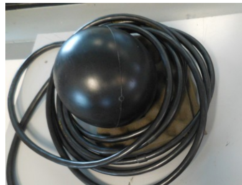
Fig. 2. Trasduttore piezoelettrico ITC 1007
