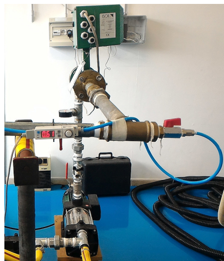
Figura 27: Il flusso d'aria passa attraverso il flussimetro e viene immesso nel circuito dell'acqua attraverso il tubicino di plastica blu visibile nell'immagine. Il flussimetro consente la misura e la regolazione del flusso d'aria.
