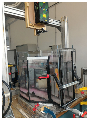
Figura 29: Sistema di acquisizione PIV visto dalla regione di uscita del getto. Sono visibili in alto la testa del laser e il sistema di lenti utilizzato per generare la lamina laser. Il varco per la comunicazione tra l'ambiente di prova e la superficie libera consente il rapido smaltimento delle bolle durante le prove.
