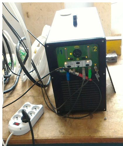
Figura 31: Dettaglio del pannello del chiller e dei cavi per la comunicazione dei segnali TTL di trigger per l'apertura del Q-Switch, provenienti dal sincronizzatore.
