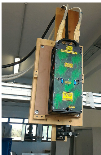
Figura 30: Dettaglio della testa laser. Sono visibili i tubi di ingresso e di uscita del liquido refrigerante proveniente dal chiller, il cavo di potenza e il cilindro di alloggiamento del sistema di lenti utilizzato per generare la lamina.
