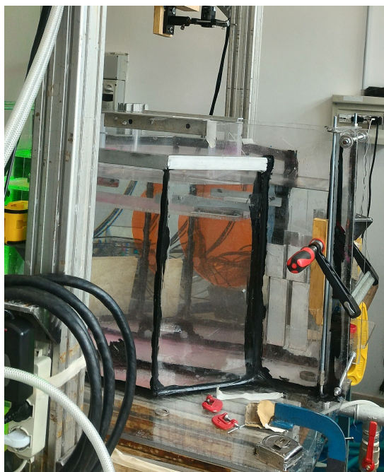
Figura 24: Vista laterale del sistema sperimentale. L'estensione del tetto della sezione di prova lascia aperto un varco per la comunicazione tra l'ambiente di prova e la superficie libera, consentendo il rapido smaltimento delle bolle durante le prove. Una pinna prismatica, visibile sulla sinistra dell'immagine, consente l'accesso ottico al di sotto della superficie libera.
