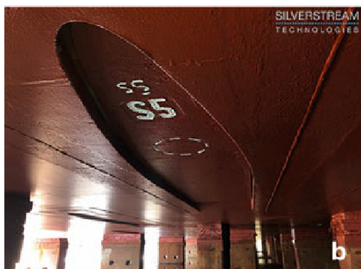
Figura 16: Vista dal basso della camera di rilascio dell'aria del sistema Silverstream .
