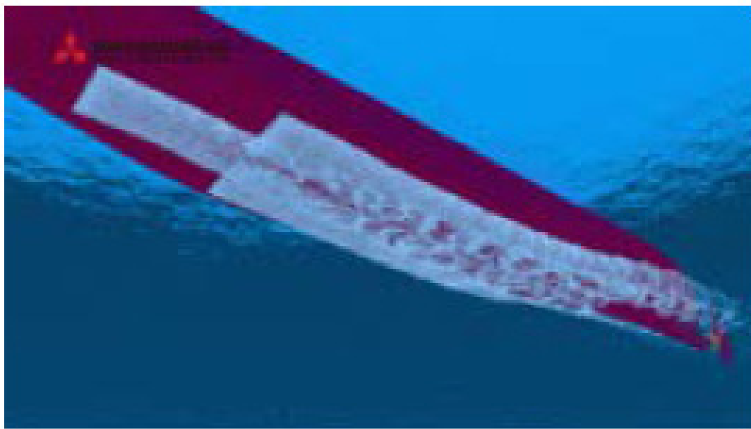
Figura 19: Rappresentazione del concetto MALS: le bolle d'aria coprono il fondo della nave, come un tappeto d'aria.
