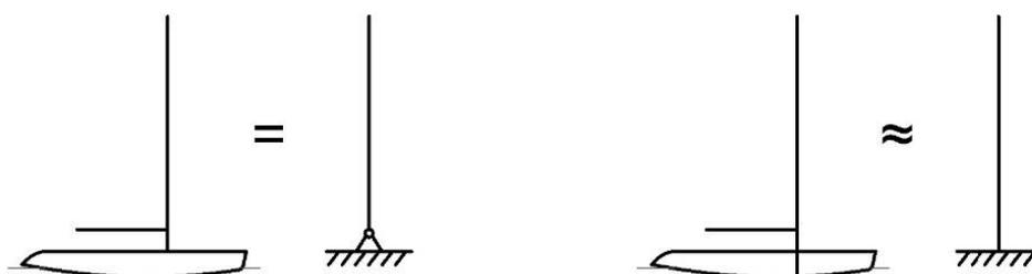
Figura 2: Schematizzazione del vincolo in piede d'albero [3].
