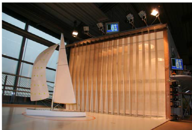
Figura 30: Modello utilizzato nello studio di Graf e Müller in galleria del vento [25].
