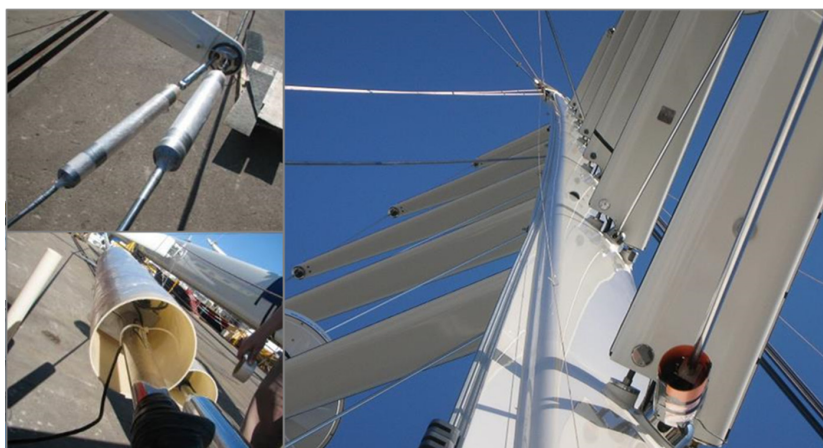
Figura 13: Protezione dei sensori con tubi in PVC.
