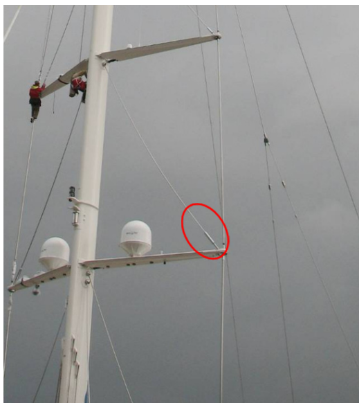
Figura 42: Dettaglio dell'arridatoio di una sartia diagonale su uno yacht Perini [18].
