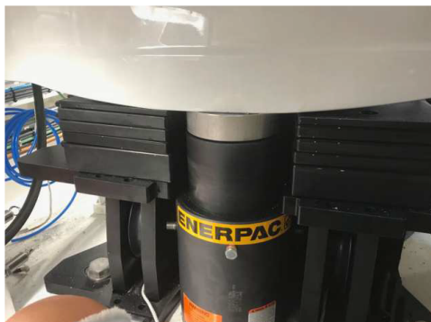
Figura 43: Mast-jack alla base d'albero con spessori per il sollevamento posizionati [29, 30].
