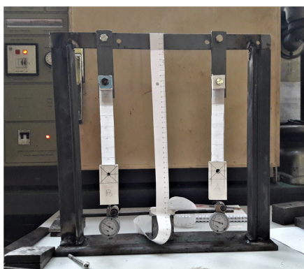
Figura 61: Struttura alla quale vengono appesi i due provini, con al di sotto i due comparatori micrometrici [36].
