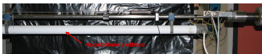
Figura 8: Prove di dilatazione termica sulla sartia con sensore LVDT.
