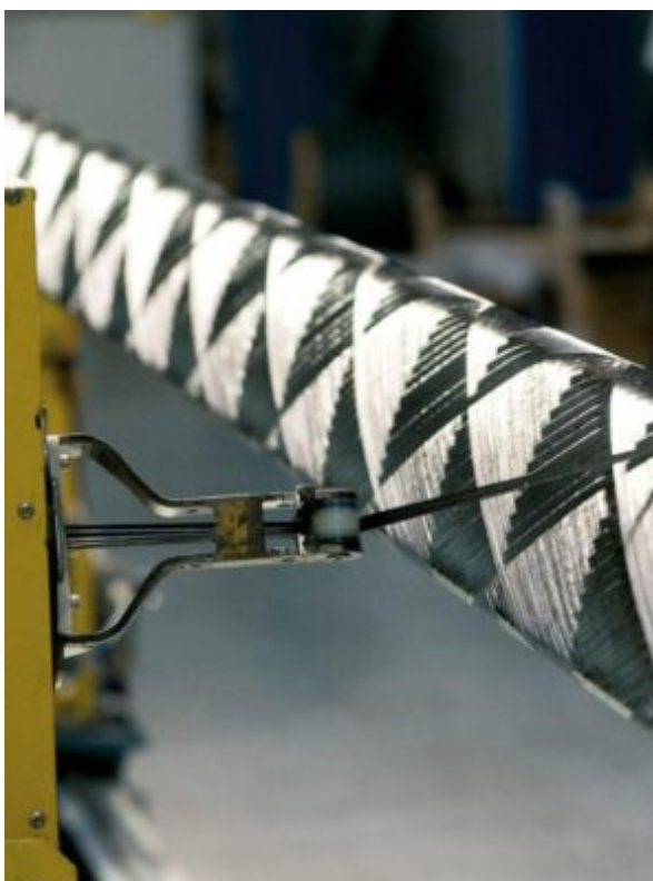
Figura 7: Filament winding di un albero in carbonio, Seldén Masts [4].
