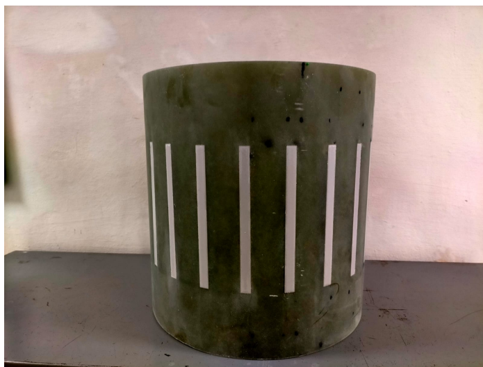
Figura 4: Cilindro con inserti ceramici.
