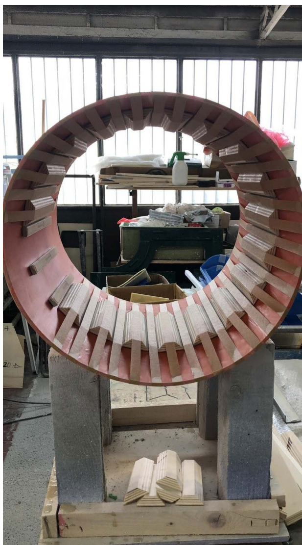
Figura 2: Stampo del cilindro durante l'applicazione degli inserti in ceramica.
